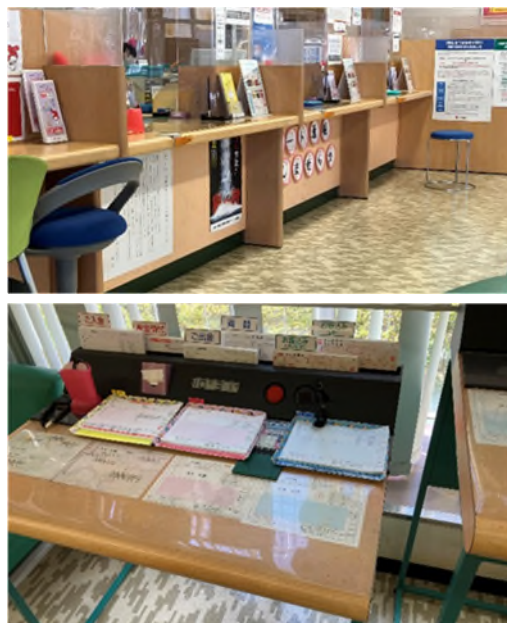
▲ 大分銀行 太陽の家支店のカウンター(上)、記帳台(下)。いずれも、車いすのまま利用できる高さに設定。また、記帳台は記入用紙が取りやすいよう、通常の位置よりも手前に設置するなど工夫されている。
